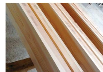
元玉大径丸太の外周部からは、節や干割れのない美しい芯去り材が採取できます。さらに、中温域で熱処理および乾燥させるため、木材本来の美しい色艶を保持。また平角材においては、大径材から芯去り製材を行うことで従来の芯持ち材よりも強度が向上。意匠性が高く、強度や寸法安定性に優れた高品質な製品の生産を可能にしました。
