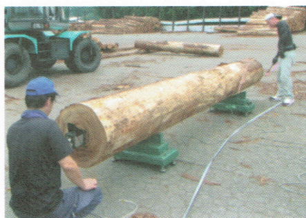
写真-3 丸太のヤング係数の調査状況
