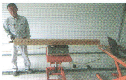
写真-4 製材のヤング係数の調査状況
