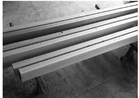
▲写真③ 中温域乾燥故の色艶と節・干割れ抑制の得意匠性能
