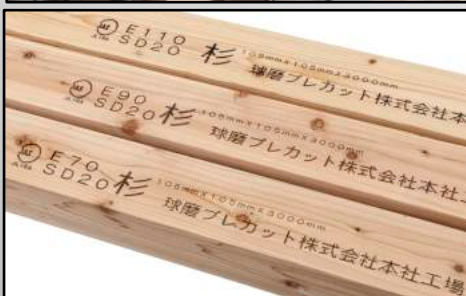
上：強度(ヤング係数)計測の様子 下：JAS表示 部材に印字されているEは木材強度を示すヤング係数。SDは含水率を示す。
