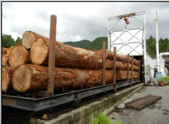
杉大径丸太の熱処理風景
