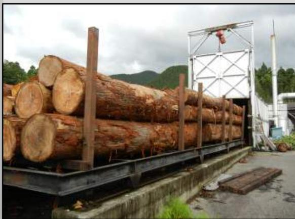
大径丸太の熱処理の様子
