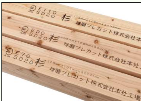
上：強度(ヤング係数)計測の様子 下：JAS表示 部材に印字されているEは木材強度を示すヤング係数。SDは含水率を示している。
