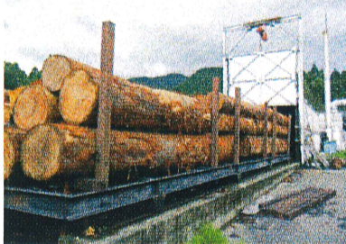
事前に丸太を熱処理し応力等を緩和させる
