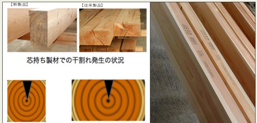
干割れは、連続する繊維(年輪)が、乾燥収縮により破断して発生します。しかしながら芯取り製材には、連続して繋がる年輪が無く、その発生が抑制されます。
