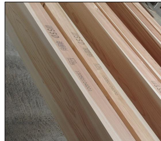
干割れは、連続する繊維(年輪)が、乾燥収縮により破断して発生する。しかしながら芯去り製材には、連続した年輪が無く、破断：割れが起り難い。
