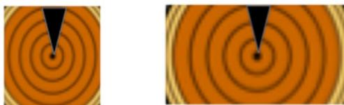
円状に連続して繋がる年輪が、乾燥収縮に伴い破断した結果が「干割れ」と理解出来る。
