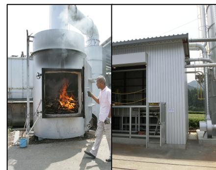
製材品の製造には0.286t-Co<sub>2</sub>/m<sup>3</sup>のCO<sub>2</sub>排出が伴うが、その内、乾燥行程の排出が0.244t-Co<sub>2</sub>/m<sup>3</sup>と殆どを占める。当方において、熱処理及び仕上げ乾燥行程の燃料はバイオマスで、全て場内発生の木屑を使用する為、カーボンニュートラル観点からCO<sub>2</sub>排出は極々僅かではない。
