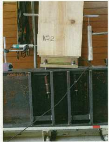
No. 2 試験体 加力終了時の加力側柱脚部ボルトの変形
