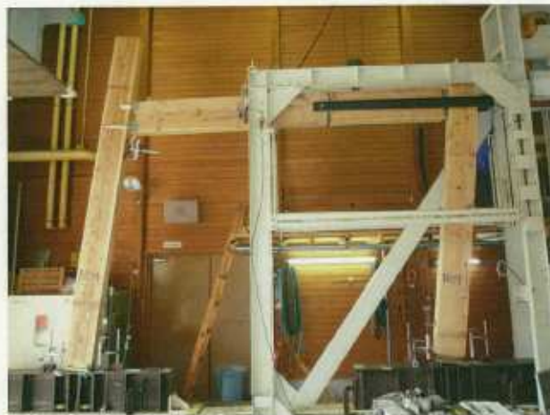
No. 4 試験体加力終了時の状況
