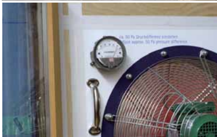
研修施設の内部 (上) サンプル集。研修内でのテスト用に使われる (下) 気密測定機
